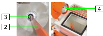
Abb. 84: Sitz der Reinigerwelle
